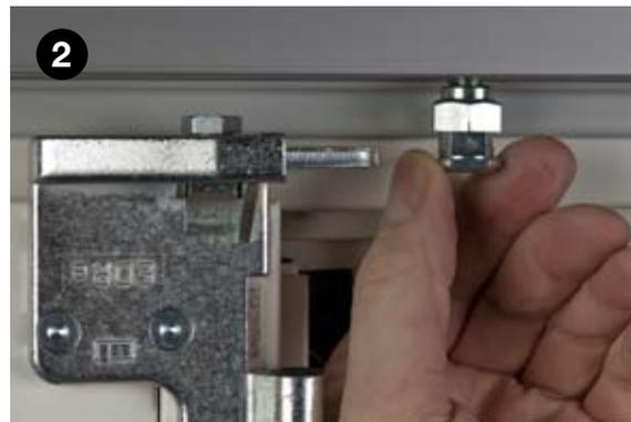
1. Die oberste Lenkrolle lösen – einen 5 mm-Innensechskantschlüssel dagegen halten und die oberste Mutter mit Hilfe eines 17 mm-Maulschlüssels lösen.
